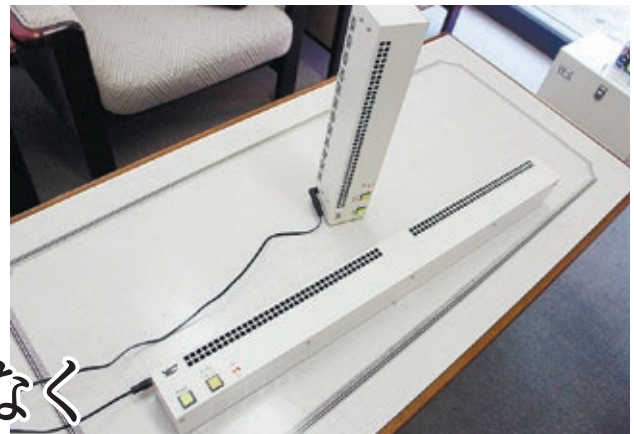
●開発した「Air Wall UV」の大(手前)と小●深紫外線LEDにより、空気が遮断された実験
