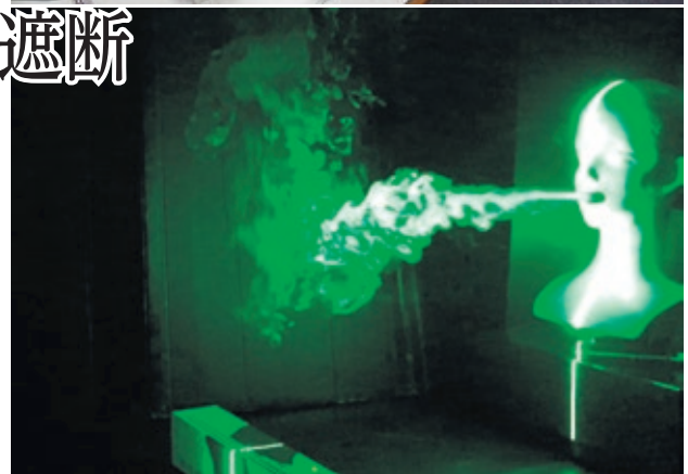
●開発した「Air Wall UV」の大(手前)と小●深紫外線LEDにより、空気が遮断された実験
